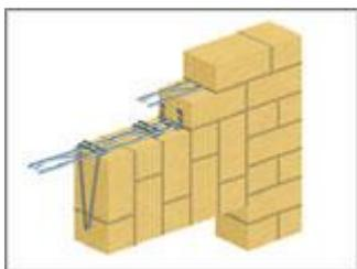
Перемышка состоит минимум из трех рядов кирпичной облицовочной кладки на традиционном растворе первый из которых уложен вертикально, в полтора кирпича, а два других - горизонтально. В каждый второй вертикальный шов первого ряда кладки заводят хомутики. В горизонтальные швы между первым и вторым, вторым и третьим рядами кладки по всей длине перемышки и за ее пределами в обе стороны располагается арматура Murfor RND/Z-50.
