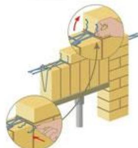
Арматура Murfor RND/Z-50 располагается и в втором ряду кладки. В обоих рядах арматура должна выходить за грани проема не менее 250 мм в обе стороны. Далее каждые 300-500 мм по высоте кладки следует располагать арматуру Murfor RND/Z-50 для достижения равномерности нагрузки на перемычку.
